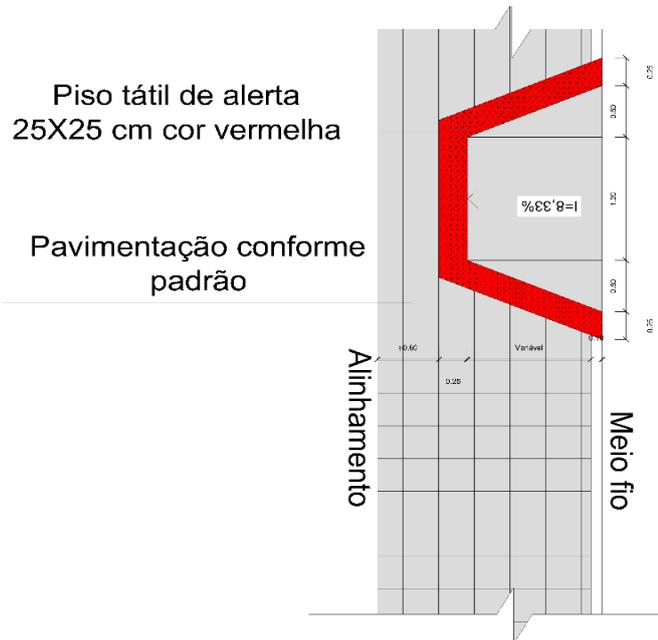
Fig. 12 – Detalhamento de rampa de acessibilidade.
