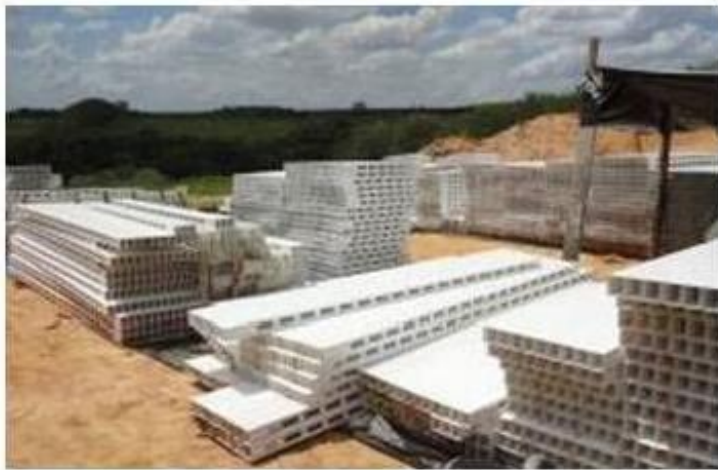
FIGURA 18 – Painéis de PVC pré-moldados na fábrica
