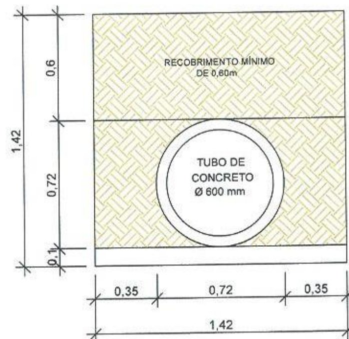
Detalhe para escavação e reaterro - Tubo 600mm Medidas em metros Sem escala
